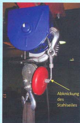
Benutzung mit Doppelzug (Zweiseil-Betrieb): Der Abschaltbügel wird durch den Hebehaken mit Umlenkrolle betätigt und nicht durch das Abschaltgewicht wie bei der Benutzung mit einfachem Zug (Einseil-Betrieb)
